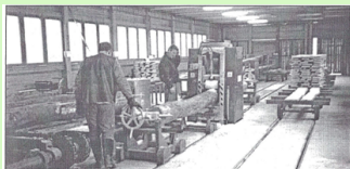
Obr. 47. Pilnice s jednou rámovou pilou - pořez asi 4 tis. m 3 kvalitní ročně
